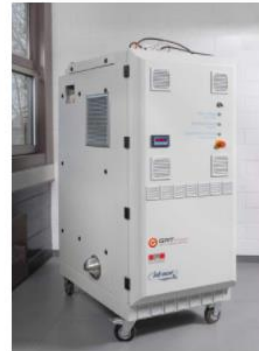
Der Generator kombiniert einen katalytischen Methansäure-Reformer (als H 2 -Quelle) mit einer handelsüblichen Polymerelektrolyt-(PEM)-Brennstoffzelle. Bild: GRT
