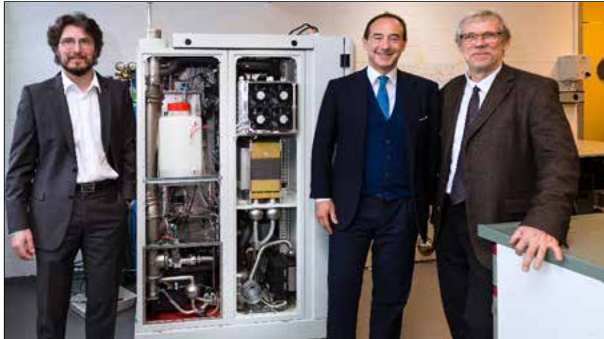
Démonstration en mars dernier avec la machine Hyform-PEMFC, renfermant la première une pile à combustible intégrée à acide formique-hydrogène permettant de stocker l'hydrogène. De gauche à droite, le Dr Nordahl Autissier, Senior Project Manager, GRT Group, Luca Dal Fabbro et le Prof. Gabor Laurenczy, EPFL. COPYRIGHT GRT GROUP
